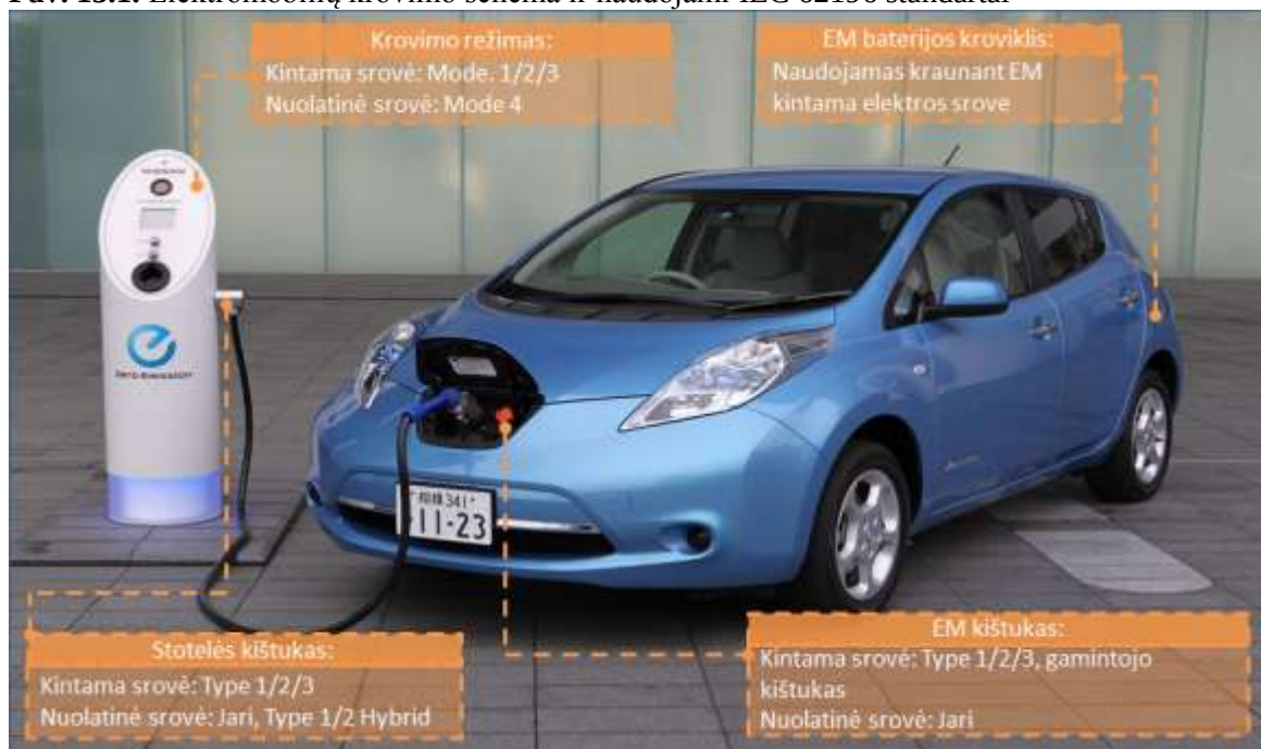
Pav. 15.1. Elektromobilių krovimo schema ir naudojami IEC 62196 standartai
